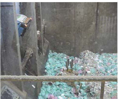
ごみピットとごみクレーン。プラットフォームから投入されたごみをクレーンで持ち上げ、落として攪拌する。
