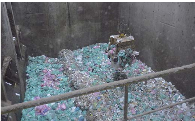
ごみピットとごみクレーン。プラットフォームから投入されたごみをクレーンで持ち上げ、落として攪拌する。
